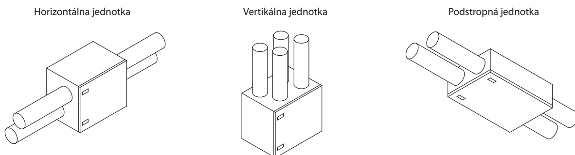
Obr. 1 Klasifikácia jednotiek podľa potrubných pripojení
